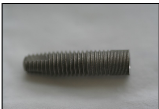
Obr. 64. Implantát PV I. z beta titanové slitiny Ti38Nb6Ta
