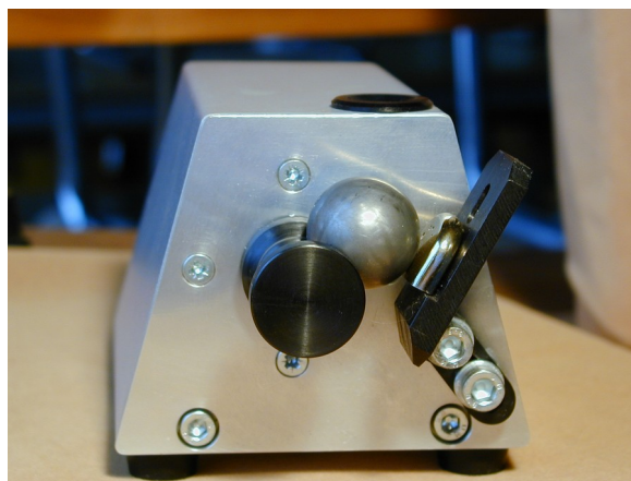
Obrázek 45: Zařízení pro měření tloušťky metodou Kalotest – kulička.
