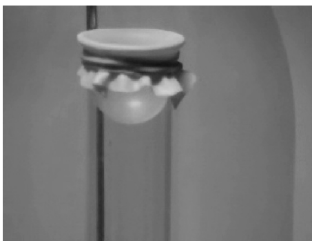
Obrázek 17. Blána prohnutá přetlakem
