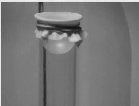
Obrázek 17. Blána prohnutá přetlakem
