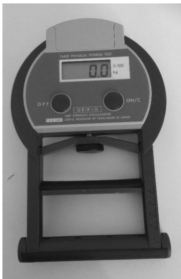
Obrázek 25. Ilustrační fotografie digitálního měřicího přístroje pro ruční dynamometrii (zdroj vlastní).
