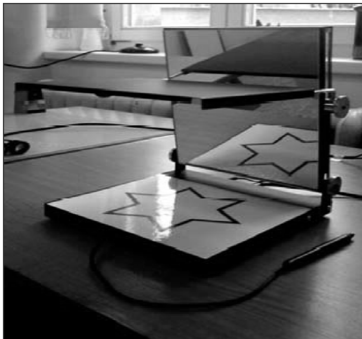
Obrázek 19. Technická část přístroje pro měření výkonu v testu zrcadlové kreslení (Benešová, 2011).
