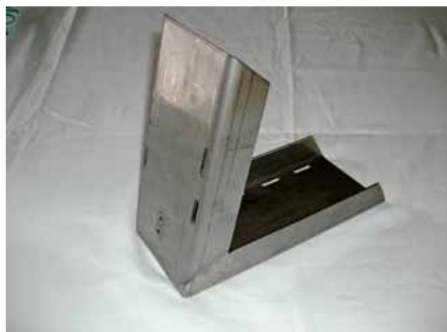
Obr.2. Kovová bota připevněná na nohu pacienta sloužící k provedení rotačních pohybů v kolenním kloubu při měření jeho stability.
